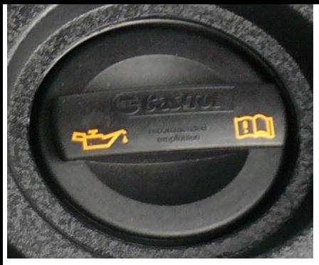
**Deckel zum Einfüllen des Motoröls**
