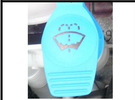
**Klappe zum Einfüllen von Scheibenwaschwasser**
