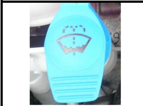
**Klappe zum Einfüllen von Scheibenwaschwasser**
