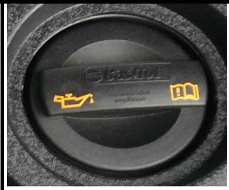
**Deckel zum Einfüllen des Motoröls**
